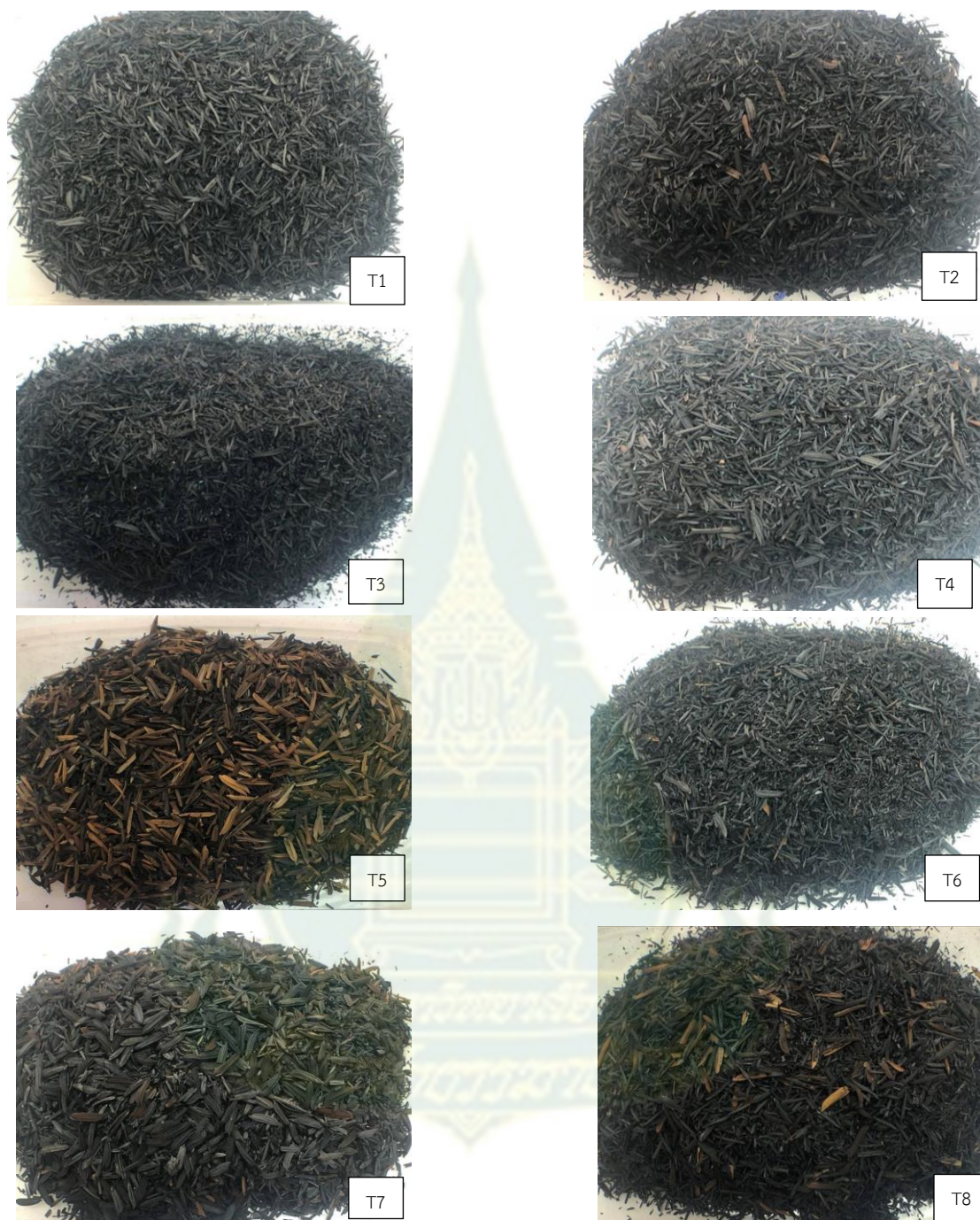
ภาพที่ 4.1 ลักษณะของเถ้าของถ่านชีวภาพจากแกลบที่ได้จากเตาเผาถ่านชีวภาพ 8 แบบ (T1: เตาเผาถ่านชีวภาพรูปแบบที่ 1, T2: เตาเผาถ่านชีวภาพรูปแบบที่ 2, T3: เตาเผาถ่านชีวภาพรูปแบบที่ 3, T4: เตาเผาถ่านชีวภาพรูปแบบที่ 4, T5: เตาเผาถ่านชีวภาพรูปแบบที่ 5, T6: เตาเผาถ่านชีวภาพรูปแบบที่ 6, T7: เตาเผาถ่านชีวภาพรูปแบบที่ 7, T8: เตาเผาถ่านชีวภาพรูปแบบที่ 8)
